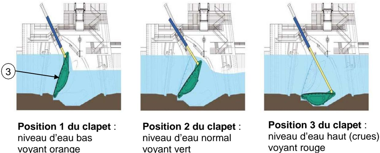
**Document 2 - Principe de fonctionnement d'un barrage à clapet**
